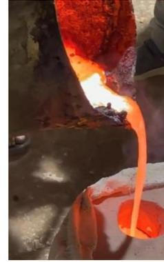
شكل (11) يبين مرحلتى تجهيز النسخة الشمع وعمل المصببات وتجهيز وصب القالب الحرارى، شكل (12) يبين مراحل عملية السباكة واخراج النسخة البرونزية المصبوبة
