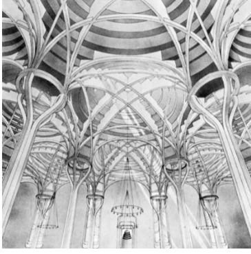
شكل (12،11) لقطات منظورية توضح التصميم الرائع لتشابك نهايات أذرع الأعمدة المركزية التي تكون شبكية معمارية أسفل القبة المركزية الرئيسية والقباب الثمانية المحيطة بها وهي غير ملامسة لقواعد تلك القباب
