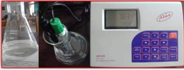
شكل رقم (5) قياس الأس الهيدروجيني بواسطة جهاز القياس الرقمي ، تصوير الباحث .
