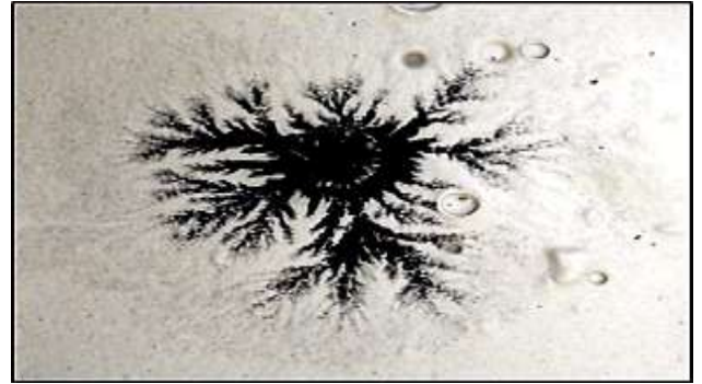
شكل (١٨) يوضح تأثير عصير الليمون المركز علي انتشار اكسيد الكوبالت علي البطانة .
