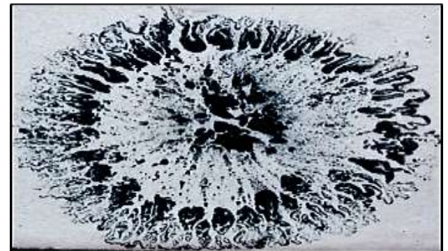
شكل (١٩) يوضح تأثير زيت التربنتين علي انتشار اكسيد الكوبالت علي البطانة .
