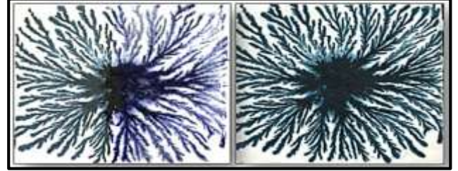
شكل ( ٩أ ) يوضح التشعب الناتج من استخدام اكسيد الكوبالت علي البطانة ، شكل ( ٩ ب ) يوضح نتيجة التشعب بعد حرق البسكويك وتطبيق الطلاء الزجاجي الشفاف .
