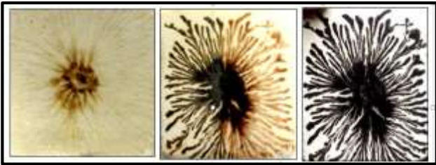
شكل ( ١٢ أ ) يوضح التشعب الناتج من استخدام اكسيد المنجنيز علي البطانة ، شكل ( ١٢ ب ) يوضح نتيجة التشعب بعد حرق البسكويك وتطبيق الطلاء الزجاجي الشفاف لأكسيد المنجنيز ، شكل ( ١٢ ج ) يوضح شكل الانتشار بعد حرق الطلاء الزجاجي في درجة حرارة اعلي من ١٠٠٠ درجة مئوية لأكسيد المنجنيز .
