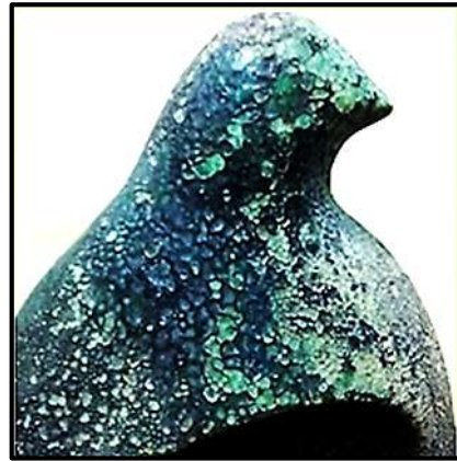
شكل توضيحي يظهر به حدوث نتوءات وانتفاخات التي تظهر علي جسد الطائر الخزفي .
