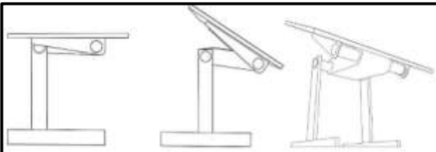
مسقط جانبي يوضح آلية الحركة للطاولات وسهولة ضبط اتجاه وزاوية الطاولات ، تصميم المقاعد (من عمل الباحثين).
