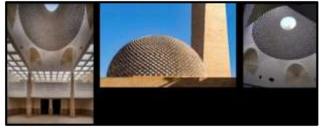
شكل(١٧) يوضح ان القبة بنيت بطريقة بها بروز منتظمة من الداخل والخارج.
