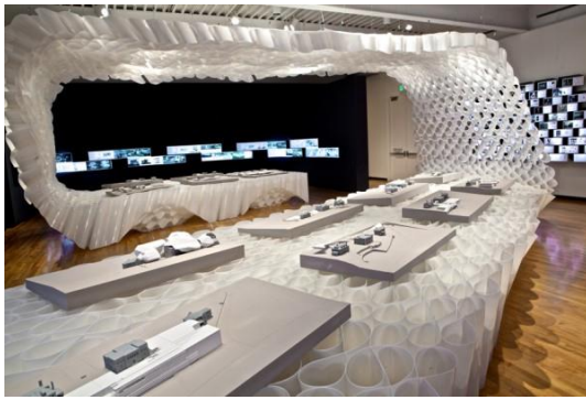
شكل ( 16 ) يوضح التصميم النهائي لشكل القاطوع باستخدام الواح البولي إيثيلين وتقنيات التصنيع الرقمى CNC
