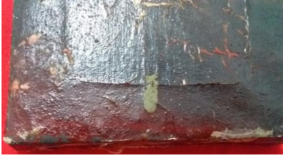
صورة رقم (7) توضح مظهر الهشاشة بطبقة الورنيش وارضية التصوير باللوحة (A)
