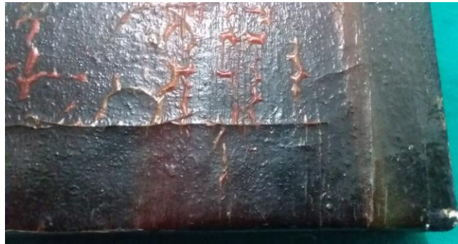
صورة رقم (8) توضح مظهر الإضمحلال (البهتان) بطبقة اللون باللوحة التجريبية (A)
