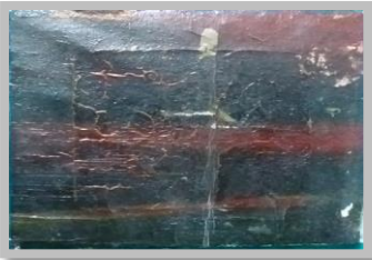
صورة رقم (13) اللوحة (A) بعد تعرضها للحرارة والرطوبة
