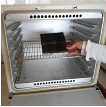
صورة رقم (3) توضح الغرفة الزجاجية المعدة لرفع نسب الرطوبة بالوسط المحيط باللوحة
