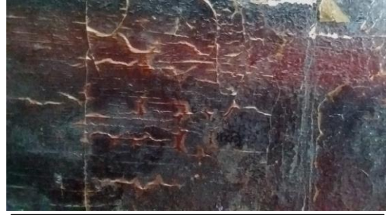
صورة رقم (6) توضح مظهر الكراكيلير بطبقة الورنيش والدكانة بطبقة اللون باللوحة التجريبية
